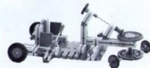
Abb. 8: Modell einer Seifenkiste mit tiefliegendem Schwerpunkt, Bodenschleifbremse und Übertragung der Lenkbewegung durch Zahnräder.
