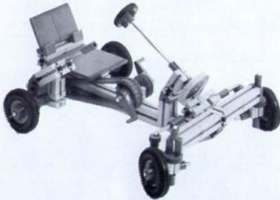
Abb. 10: Funktionsmodell einer Zahnstangenlenkung mit einseitigem Lenkhebel.
