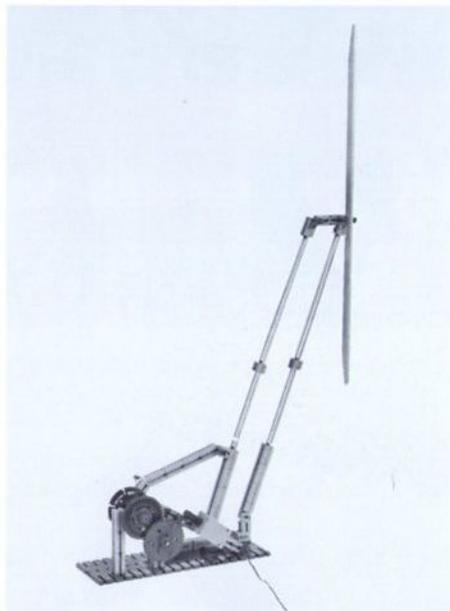
Abb. 34 bis 37: Funktionsmodelle von Scheibenwischern aus dem Lernprogramm zur Getriebelehre Serie C Satz II
