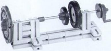
Abb. 31: Funktionsmodell einer Reibkuppelung (Scheibenkuppelung) - ausgekuppelt.
