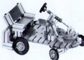
Abb. 7: Modell einer Seifenkiste mit Seilzugfußbremse und der für Seifenkistenrennen vorgeschriebenen Seilzuglenkung.
