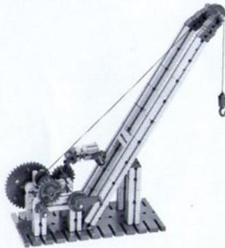
Abb. 12: Funktionsmodell eines Krans mit starrem Ausleger und Hubwerk zur Verringerung des Kraftaufwandes.
