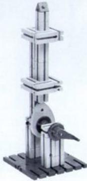
Abb. 38: Ebenes Kurvengetriebe mit Nockenscheibe zur Umsetzung einer Drehbewegung in eine Auf- und Abbewegung.
